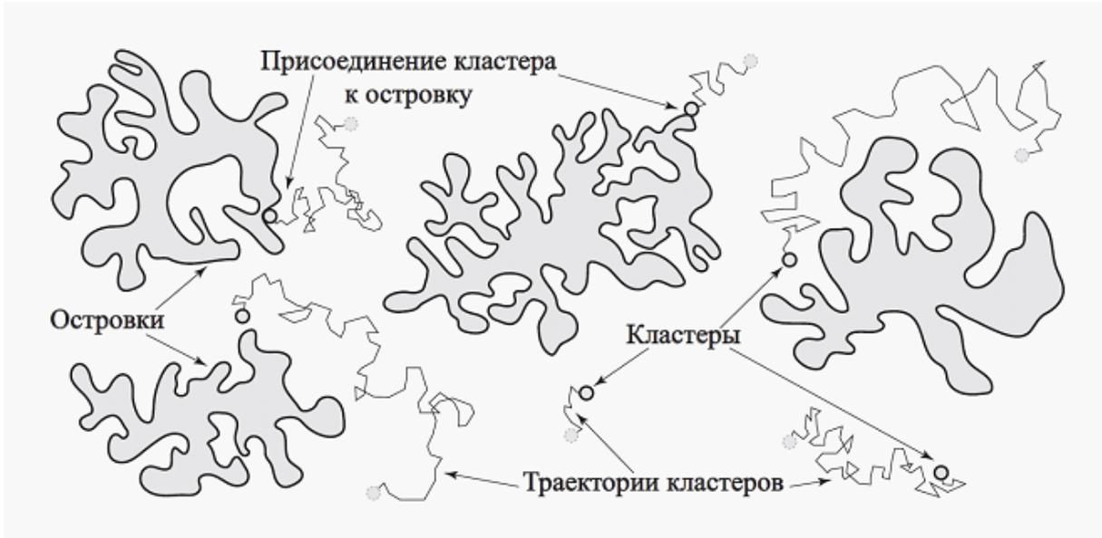
Рис. 66: Осаждение холодных кластеров, разогрев и присоединение к островку
